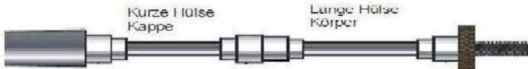
Kurze Hülse a 14,3 mm / i 11,5 mm      lange Hülse a 12 mm / i 9,5 mm
