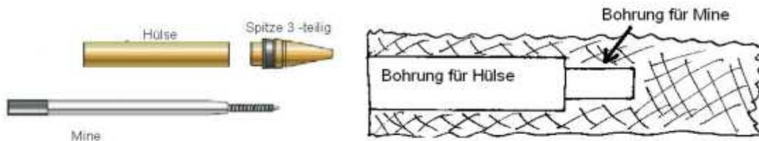
>Erstellen Sie in dem ausgewählten Rohling für die Hülse eine Bohrung  $\varnothing$  10 mm,
