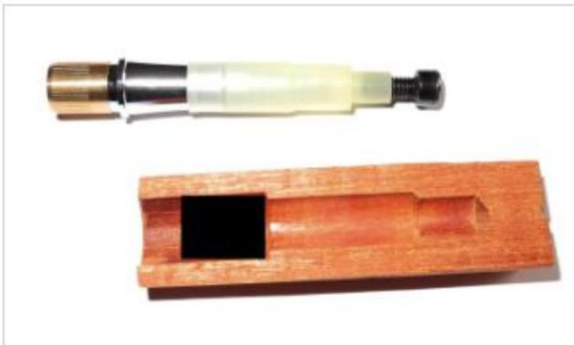
Falls gewünscht, kann auf die Dichtkappe ein M4-Gewinde aufgeschraubt werden; in der Kappe ist eine entsprechende Schlitzaufnahme. Wenn nur der M4-Schraubkopf eingeklebt wird, ist der Druckausgleich gegeben und es kann noch zusätzlich die Einsatztiefe hoch oder runter justiert werden.
