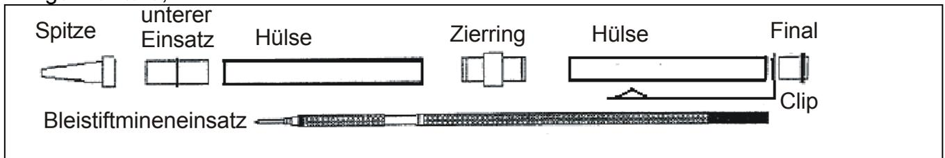
>Markieren Sie den Holzrohling mittig im Maserungsverlauf, schneiden Sie den Holzrohling entsprechend der Hüslenlänge (+ ca 2 mm)
