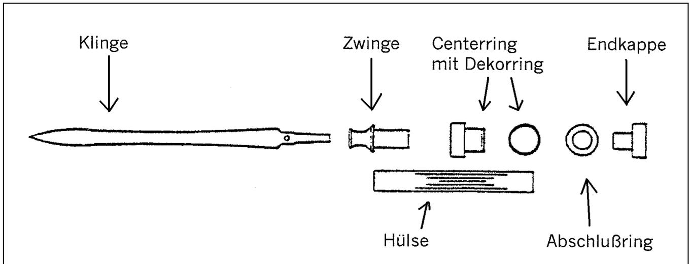
>Schneiden Sie den Holzrohling entsprechend der Hülslänge (+ ca 2 mm), bohren Sie den Rohling. Kleben Sie die Hülse ein (wir empfehlen Starbond Glue EM 150, Hülslen evtl. außen leicht anschleifen)
