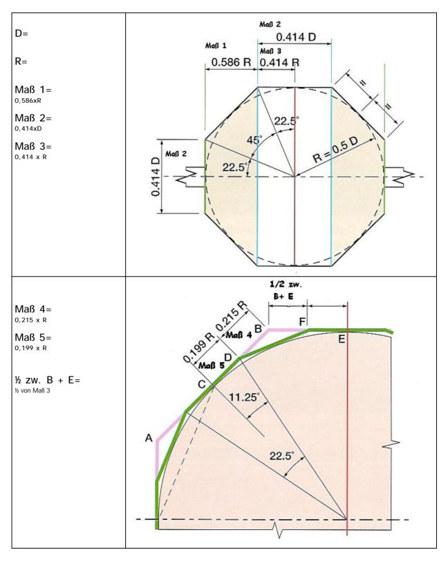
Bei einer Serie von Kugeln fertigt man am einfachsten eine Schablone mit den vorausberechneten Maßen.
