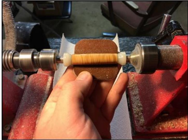
Mit den beiden „groben“ Körnungen des Sets 1500 und 1800 (vergleichbar mit 400er und 800er Korn deutscher Norm) schleife ich unter Verwendung von Wasser so lange, bis ich keine Glanzstellen mehr in den „Tälern“ habe und alle „Berge“ sauber verschliffen sind.
